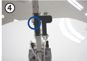
Secure cables(2EA) using a cable tie.
